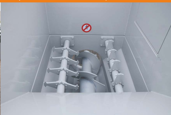
SVS 11 met vrijstoter (voor een optimale invoer van materiaal)
