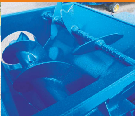
SVS 11 met vrijstoter (voor een optimale invoer van materiaal)
