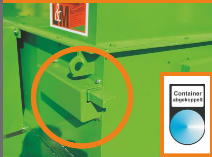
Veiligheidsschakeling / container-controle met signaallampje
