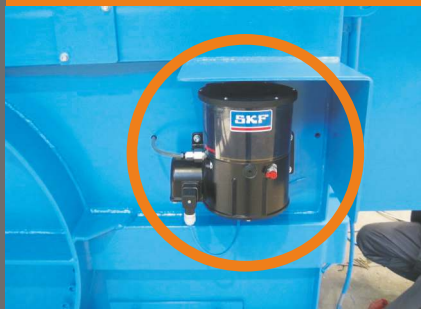
Automatisch centraal smeersysteem voor het schroeflager (standaard)
