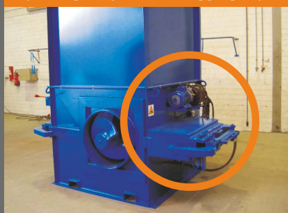
SVS 15 met hydr. aankoppeling (met eigen hydraulisch aggregaat)
