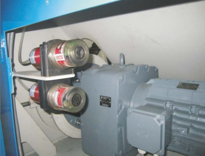
Automatische centrale smering met instelbaar interval
