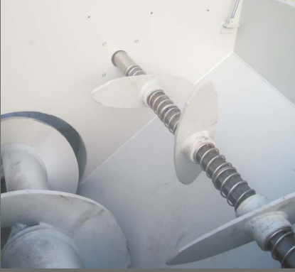
Vrijstoter (met eigen aandrijving) voor circulatie van het materiaal
