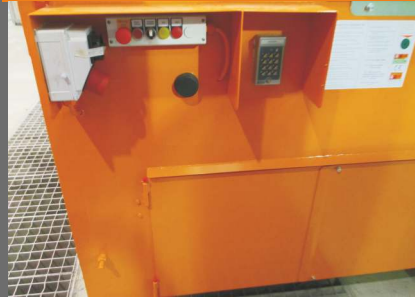
SPB LM 23 SPS met GSM-meldsysteem en met PIN-code
