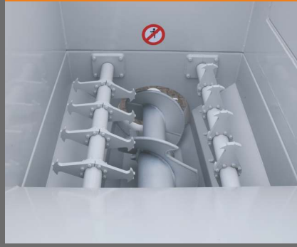
Versterkte schroef en 2 versnipperassen voor het versnipperen van hout
