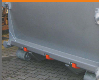
Centrale vergrendeling die bediend wordt met de ratel van de deurvergrendeling
