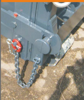
Vangkabel bij de ledigingsdeur tegen ongecontroleerd openen (standaard)
