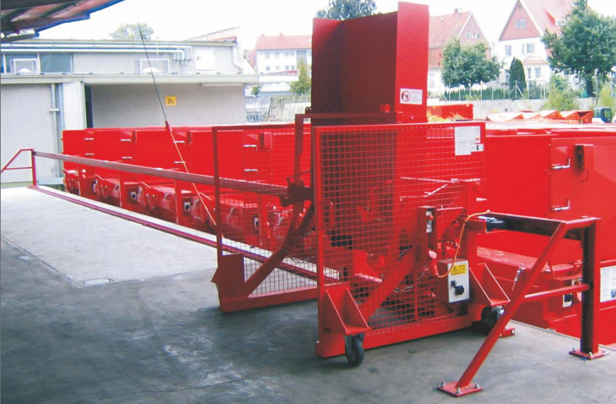
Dwars mobiele HKV voor 660-1.100 liter MGB met automatische dekselopener
