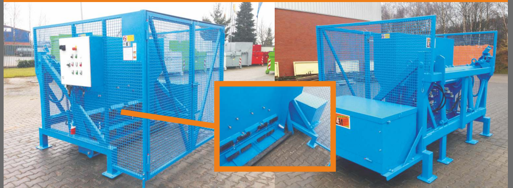
Stationaire HKV met extra hefvermogen, veiligheidskooi met vleugeldeur met eindschakelaar en sensorgestuurd pneumatisch dekselopeningssysteem voor containers van beschermingscategorie 3
