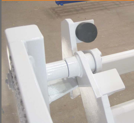
Instelbare rubberbuffer als zwenkarmaanslag
