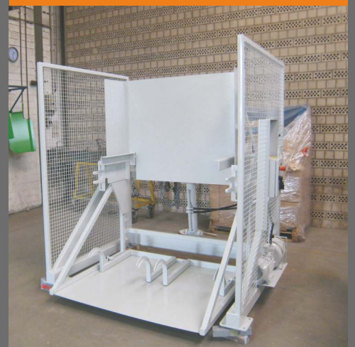
Stationaire HKV voor 2 x 240 liter of 1 x 660-1.100 liter MGB of diverse Zarges-containers
