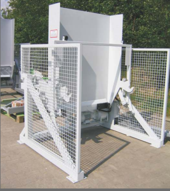
Dwars mobiele HKV voor 660-1.100 liter MGB met automatische dekselopener
