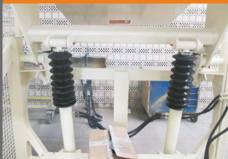
HKV met spatbescherming voor de zuigerstangen (bijv. voor zuurhoudend materiaal)
