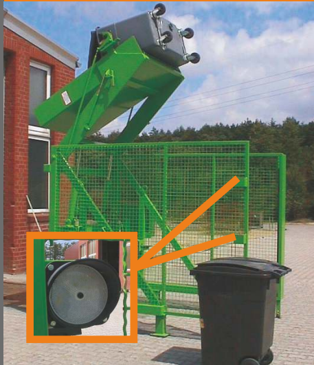
Stat. HKV met verlengd veiligheidshek en fotocelgordijn
