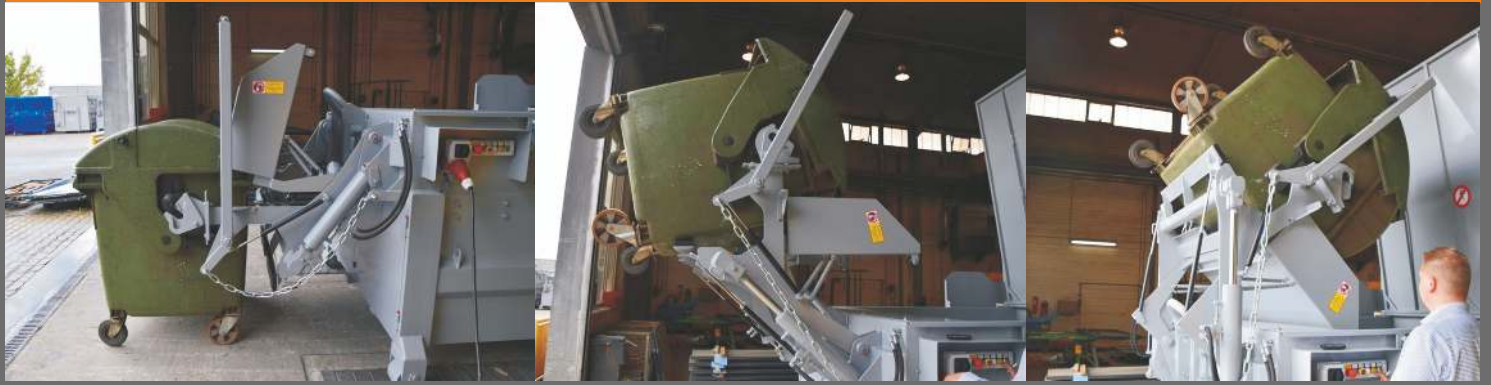
Aangebouwde HKV voor 2 x 240 liter of 1 x 660-1.100 liter MGB met automatische dekselopener
