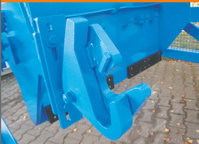
In de hoogte instelbare en automatisch vergrendelende penopname voor 660-1.100 liter MGB conform DIN EN 840 hefinrichting
