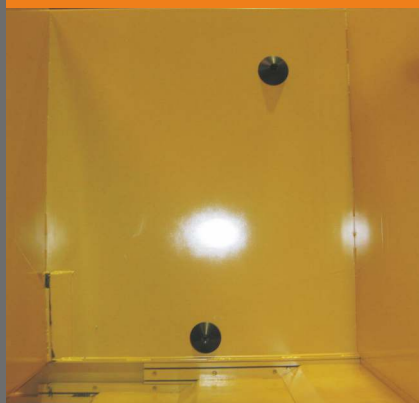
Fotocellen als start- en overloopbeveiliging in de trechteropbouw
