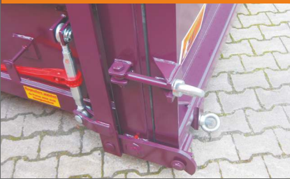
Knevelsluïtingen bij de uitvoeropening (bijvoorbeeld bij vloeïstofdichte uitvoering)
