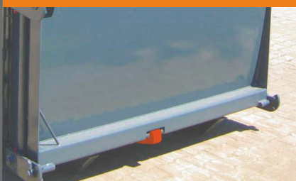
Centrale vergrendeling die bediend wordt met de ratel van de deurvergrendeling
