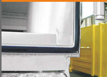
Rubberafdichting bij de uitvoeropening (bijvoorbeeld bij vloeistofdichte uitvoering)
