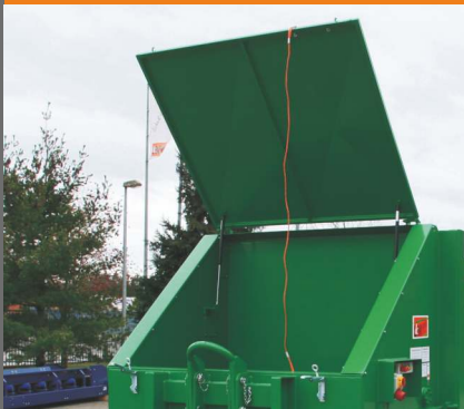
Aan de achterzijde scharnierend deksel op de vulopening
