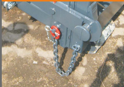
Vangketting bij de ledigingsdeur om te voorkomen dat de deur open springt (standaard)
