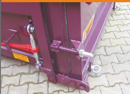
Knevelsluitingen voor de pendelklep (bijvoorbeeld bij vloeistofdichte uitvoering)
