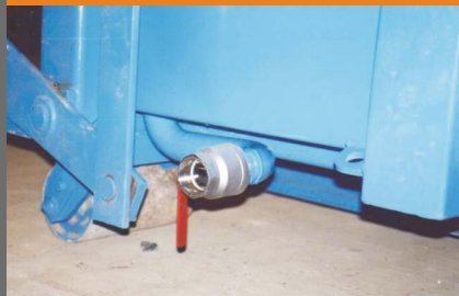
Vangketting bij de ledigingsdeur om te voorkomen dat de deur open springt (standaard)
