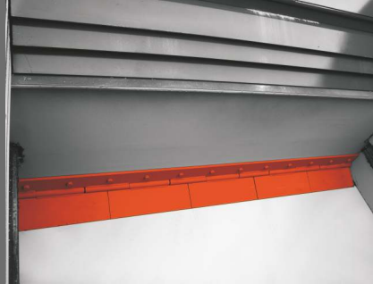
Hangende afschraper voor de persstempel
