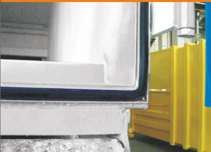
Rubberafdichting rondom bij vloeistofdichte uitvoeringen
