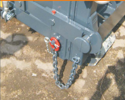
Vangketting bij de ledigingsdeur om te voorkomen dat de deur open springt.
