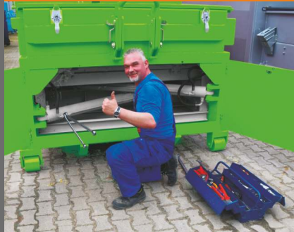
Grote reinigingskleppen met eindschakelaar aan de voorzijde
