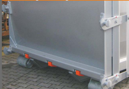
Centrale vergrendeling die bediend wordt met de ratel van de deurvergrendeling
