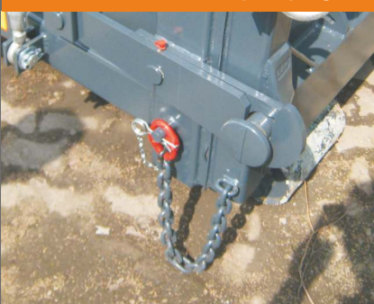
Vangketting bij de ledigingsdeur om te voorkomen dat de deur open springt.
