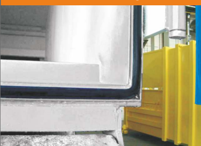
Rubberafdichting rondom bij vloeistofdichte uitvoeringen
