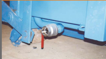
Waterafvoer met kogelkraan (bijvoorbeeld bij vloeistofdichte uitvoering)
