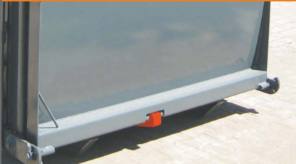
Centrale vergrendeling die bediend wordt met de ratel van de deurvergrendeling
