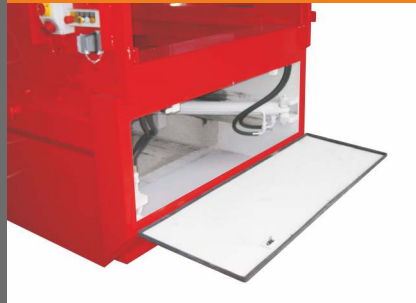
Grote reinigingsklep met eindschakelaar aan de voorzijde
