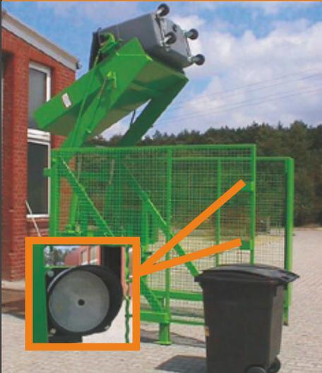
Stat. HKV für 660-1.000 Ltr. MGB mit Schutzkäfig und Positionsüberwachung
