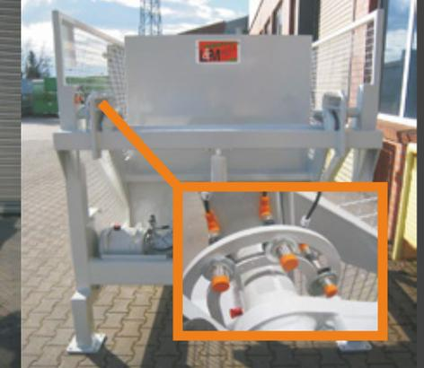
Stat. HKV mit erhöhter Hubkraft, Schutzkäfig mit Endschalter-gesicherter Flügeltür und sensorgesteuertem pneumatischem Deckelöffner für Behälter der Datenschuttklasse 3
