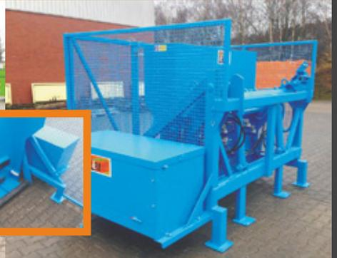
Einstellbarer Gummipuffer als Schwenkarmanschlag
