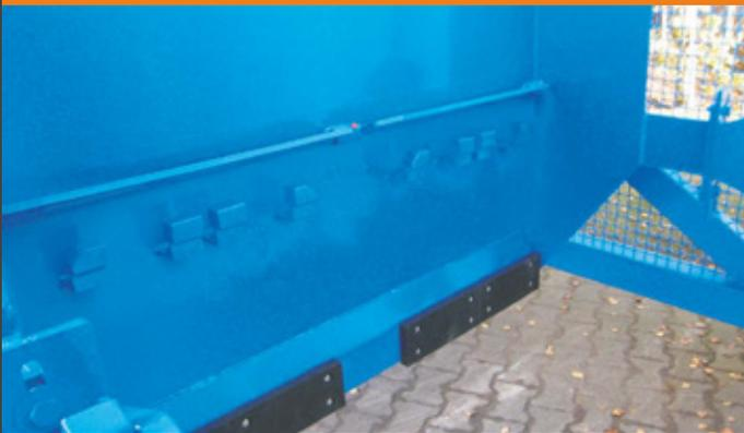
In der Höhe einstellbare und automatisch verriegelnde Zapfenaufnahme für 660-1.100 Ltr. MGB nach DIN EN 840
