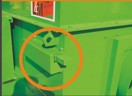
Trichteraufbau mit Sicherheitsreißleine und Fernbedienungshalter
