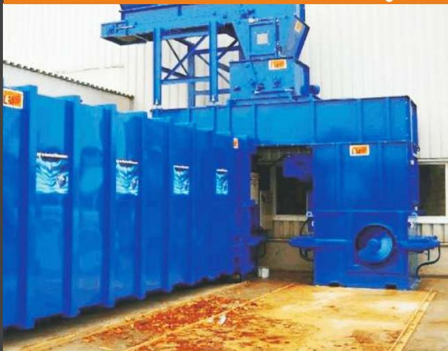
2x SSVS15 mit Hosentrichter, PC6.000 und Containerwaage
