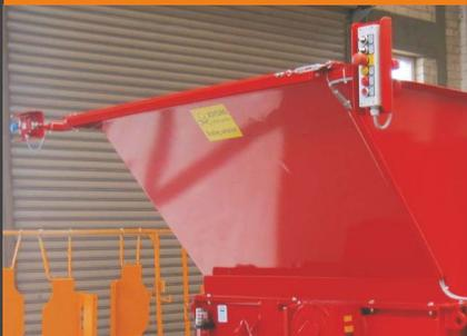
SVS 15 mit hydr. Ankopplung (mit eigenem Hydraulikaggregat)
