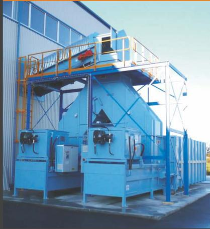
STV 1.300 mit angebauter HKV und Trichter mit Pendelklappe
