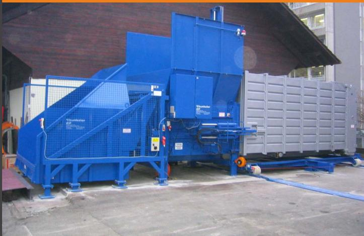
KBW 1.593 mit angebauter HKV für Sonderbehälter und Wandanschlusstrichter mit automatisch öffnender Pendelklappe
