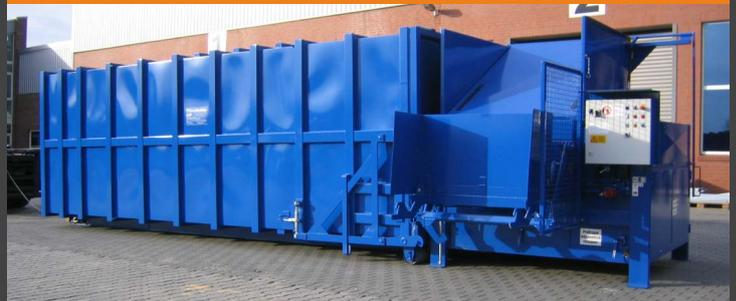
KBW 1.593 mit stat. Hub-Kippvorrichtung für Kehrricht und 1-fach Verfahrwagen
