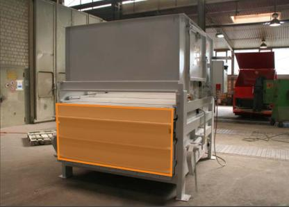
KBW 1.593 mit automatischer Containertürverschlusseinrichtung
