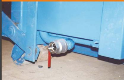
Verzinkte Wartungsstütze für Pendelklappe
