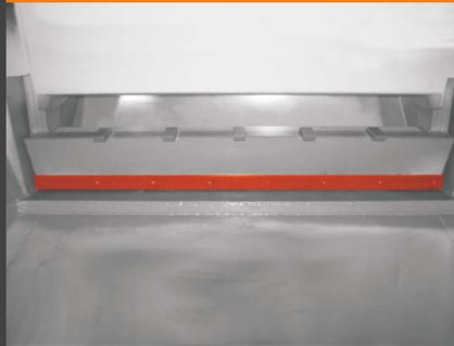
Knebelverschlüsse für die Pendelklappe (z.B. bei flüssigkeitsdichter Ausführung)
