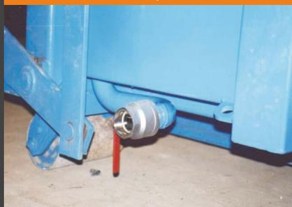
**Sicherungskette an der Entleerungstür (gegen unkontrolliertes Auspringen)**
