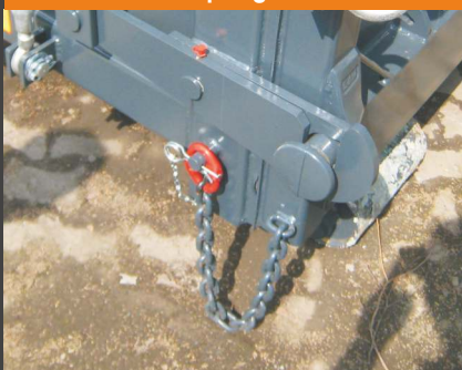
Fangkette an der Entleerungstür verhindert Aufspringen der Tür
