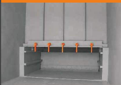
Pendelnde Rückhaltezzähne an der Brechkante
