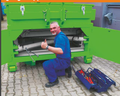
Große Endschaltesicherte Reinigungsklappen an der Stirseite
