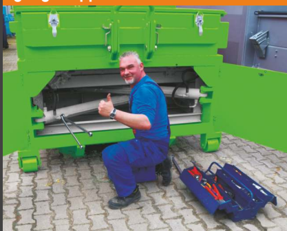
Große endschaltergesicherte Reinigungsklappen an der Stirnseite
