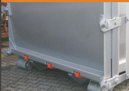
Zentralverschluss mit Betätigung über die Ratsche der Türverriegelung
