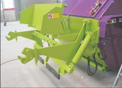
Große endschaltergesicherte stirnseitige Reinigungsklappe
