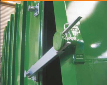
Verzinkte Ratsche für die Türverriegelung der Pendelklappe
