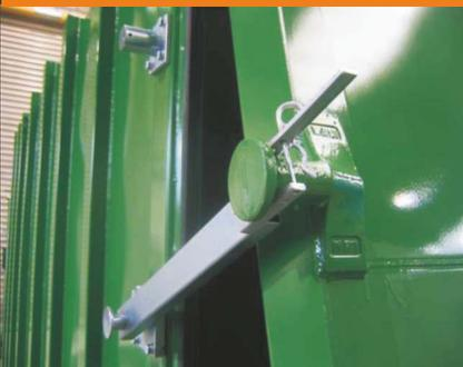
Verzinkte Ratsche für die Türverriegelung der Pendelklappe
