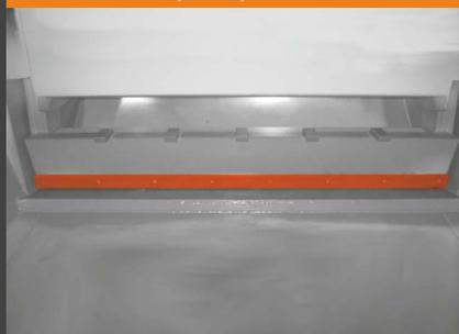
Verzinkte Wartungsstütze für Pendelklappe (Serie)
