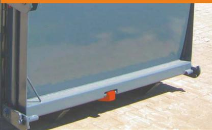
Knebelverschlüsse für die Pendelklappe (z.B. bei flüssigkeitsdichter Ausführung)
