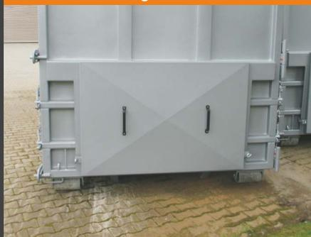
Schott zum Verschließen der Einfüllöffnung
