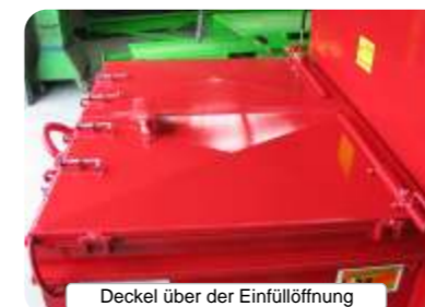
Deckel über der Einfüllöffnung
