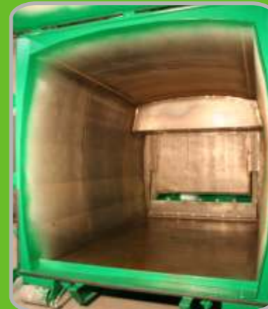
Aggregatraum, Brechkante und Presskolben
