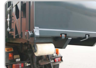
Zentralverriegelung an den Entleerungstüren
