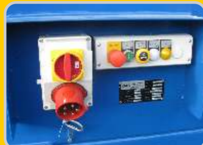
Bedientastatur, NOT-Halt, Vor-Vollmeldung, Hauptschalter, CEE-Kupplung, Phasenwender
