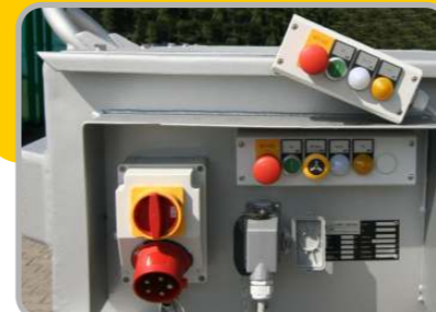
Bedientastatur mit Fernbedienung und 75 % Vor-Vollmeldung
