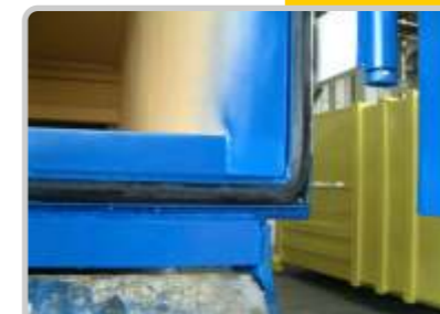
Gummidichtung an der Entleerungstür
