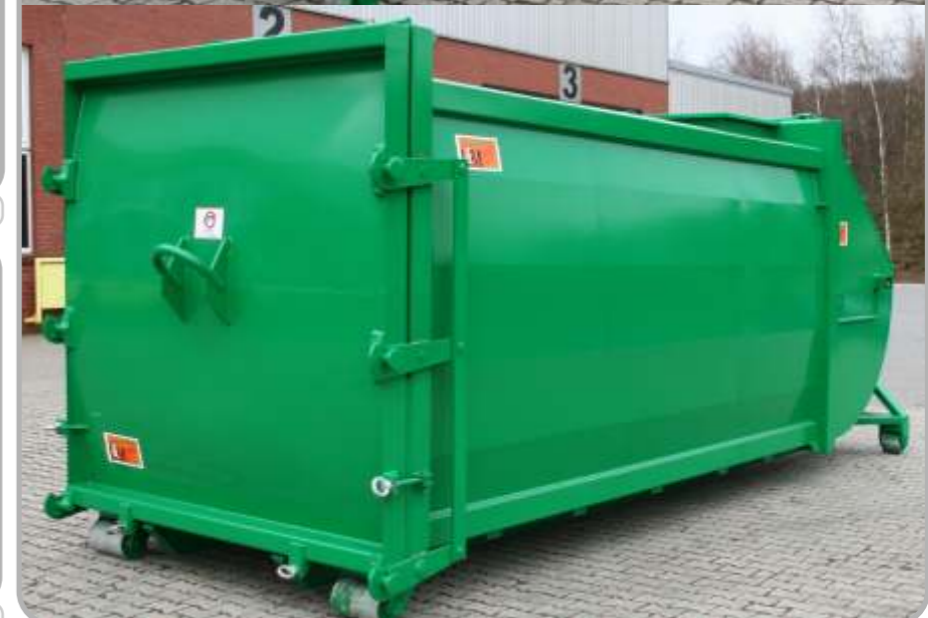
LM NP 20 RPK mit beidseitiger Hakenaufnahme
