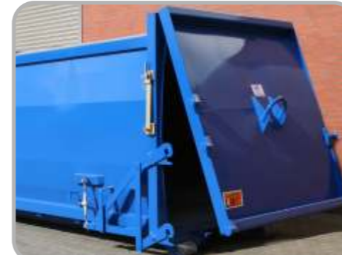
Pendelklappe mit Sicherungsstütze
