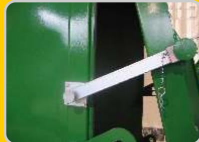
Sicherungsstütze an der Pendelklappe
