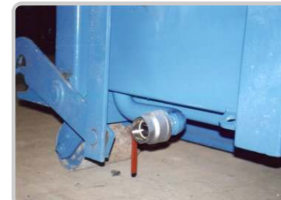
Wasserablauf über Kugelhahn
