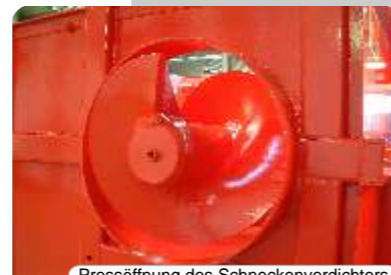
Pressöffnung des Schneckenverdichters mit stabiler, konischer Schnecke
