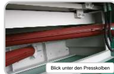
Presskolben, pendelnde Stahlabstreifer, zwei Schiebebleche.
