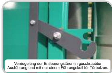
Große, schraubbare Revisionsklappen
